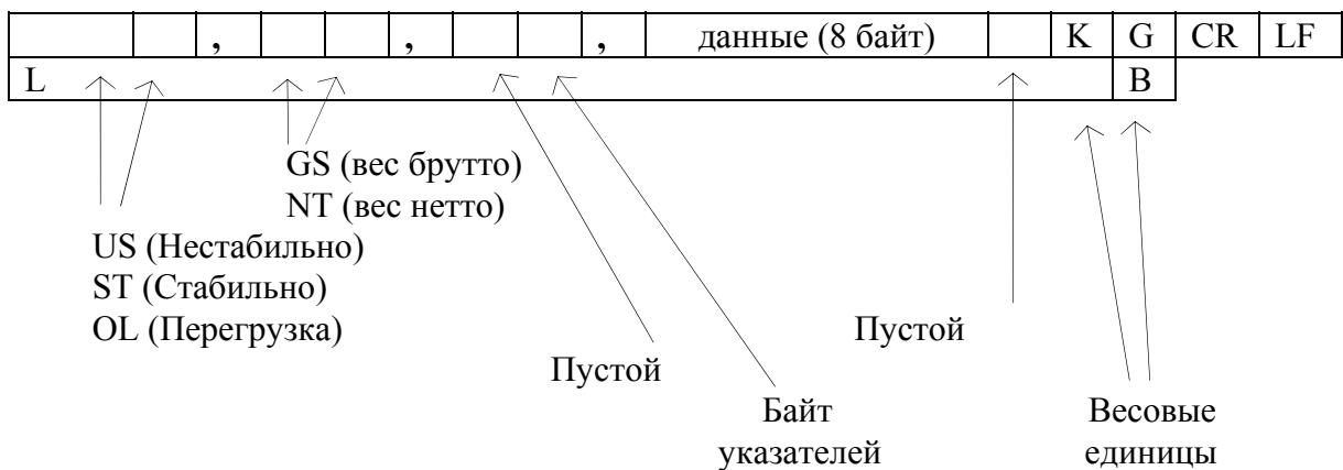
Байт указателей: сообщает о состоянии (включен или выключен) каждого из указателей на дисплее.
